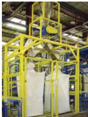
Estação abastecimento de big-bag Estación de llenado big-bag
