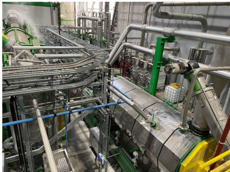
Nuestra división ECOTECH ha diseñado y desarrollado un sistema de recuperación de plástico de alta tecnología integrado en un sistema de lavado de alta eficiencia.
